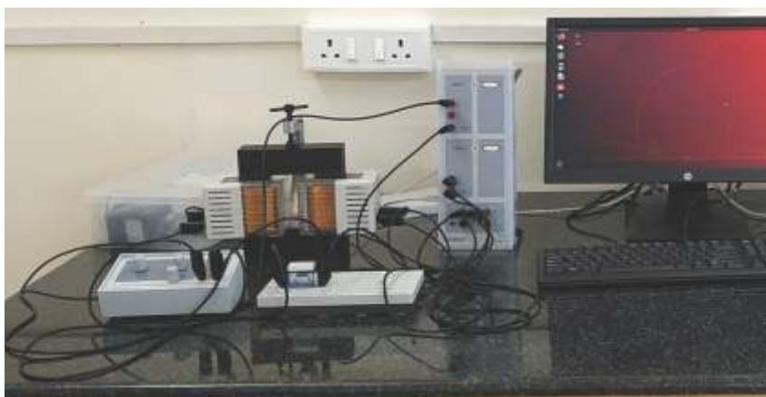
▲ Fig. 25 Ferromagnetic hysteresis apparatus
